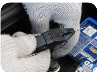
Mecanismo deslizante de agulha
