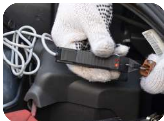
Ideal para detectar falhas em circuitos contínuos (DC)
