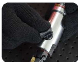
Seletor de sentido para aperto e desaperto
