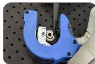
2. Retire a lâmina antiga com um alicate
