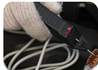
A luz acende quando detecta tensão
