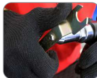
Pontas fixadoras de 2.4, 3.2, 4 e 4.8 mm
