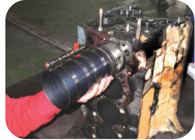
A compressão dos anéis nas ranhuras facilita a instalação e a remoção do pistão
