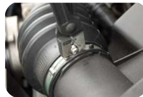
Remover e instalar abraçadeiras Clic-C e Clic-R
