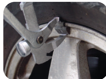
Fixa e remove os pesos de balanceamento
