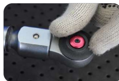
Trava de reversão. Ajuste par sentido normal e reverso
